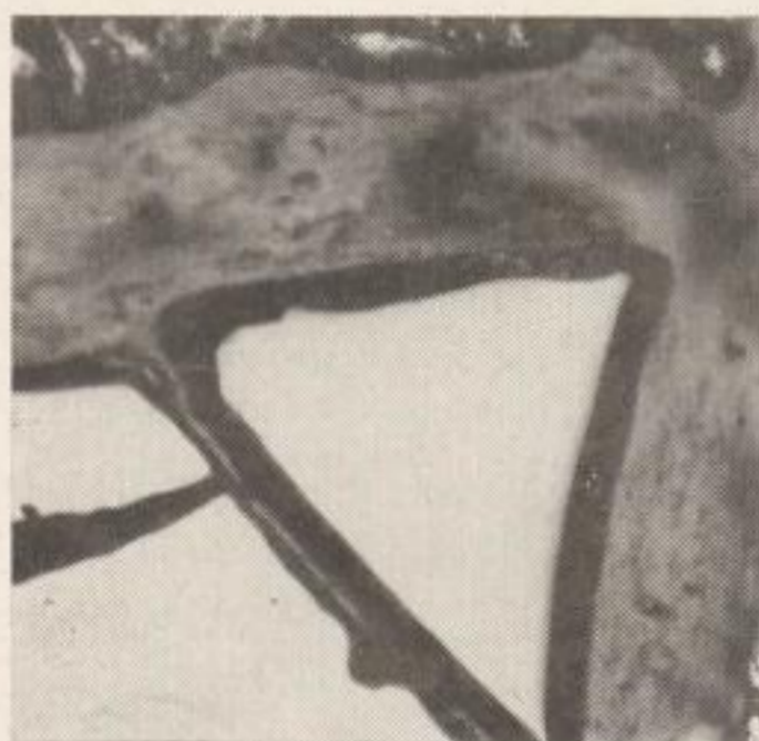
Bild 13. „Dopplerit“-Koks — BHT-Koks Lauchhammer; Hellfeld, V = 100
