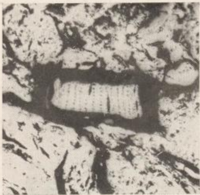
Bild 11. Koksfusit mit breiten Korngrenz-(Schwund-)rissen BHT-Koks Lauchhammer; Hellfeld, V = 100
