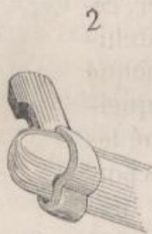
Dans la charpente, la serrurerie et la grosse menuiserie, les clavettes qui passent à travers l'extrémité des boulons sont souvent doubles à la queue; les deux pointes étant recourbées, la clavette ne pouvait plus sortir (voy. fig. 2).
