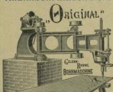
Dieselben sind leistungsfähiger, leichter zu bedienen, billiger, auch in der Unterhaltung, und erfordern weniger Betriebskraft als jede Radialbohrmaschine anderer Construction — Der 2 bis 4 Gelenkarm gestattet das Bohren ohne das Bohrstück zu verrücken. (643)
