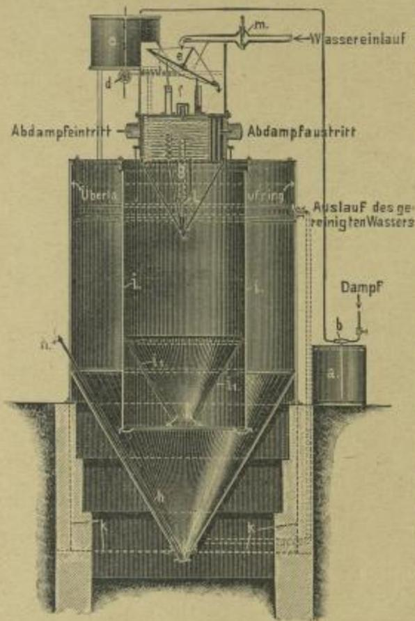
strahlelevator (b), dem Reagentienreservoir (c), dem Reagentienaufgeber (d), dem Kipptrögwassermesser (e), dem Mischgefäß (f), dem Vorwärmer (g), dem kompletten Klärapparat mit Oelabscheider (i) u. Schlammablauf (hh), welchen sich mitunter noch ein um den unteren konischen Schlammablauf angeordnetes Reservoir (kk) für gereinigtes Wasser, ein Wärmeregler (L) und ein in die Wasserzuleitung einzubauendes Schwimmventil (m) zugesellt.
