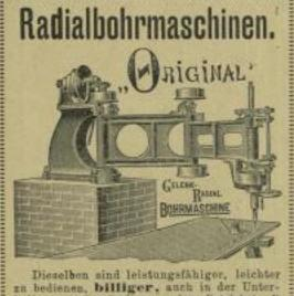
Dieselben sind leistungsfähiger, leichter za bedienen, billiger, auch in der Unterhaltung, und erfordern weniger Betriebskraft als jede Radialbohrmaschine anderer Construction — Der 2 bis 4 Gelenkarm gestattet das Bohren ohne das Bohrstück zu verräcken. (643)
