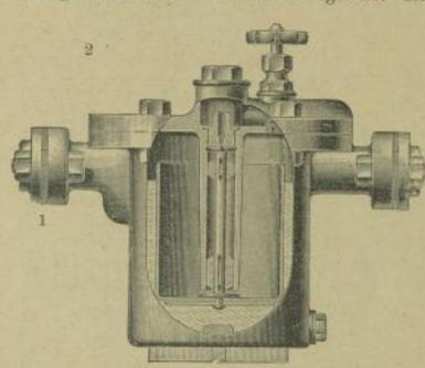
gewöhnlich ohne Entlüftung! Durch den bei 1 eintretenden Dampf wird alle Luft aus der Leitung getrieben. — Das von dem Dampf mitgeführte Wasser hebt
