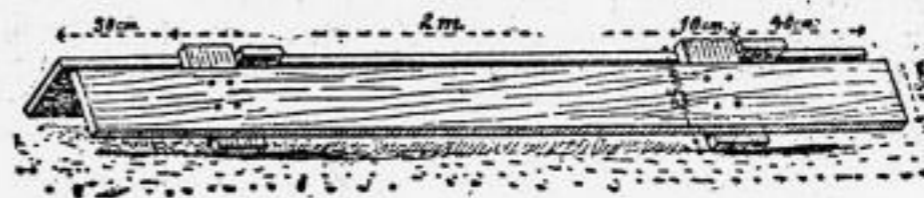
Abbildung 3 Bretter für den Lüftungskanal der Kartoffelmiete
