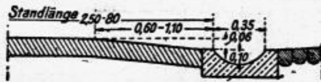
Abbildung 1 Querschnitt durch einen Rinderkurzstall mit offener Jaucherinne
