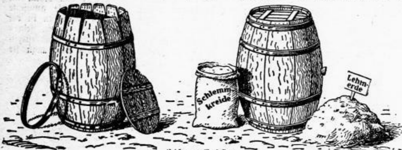
Der Kleinsilo, hergestellt aus einer alten Tonne
