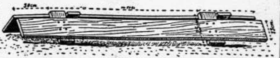
Abbildung 2. Bretter für den Lüftungskanal der Kartoffelmiete
