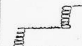
Abb. 4. Böschung mit zwei Stützmauern
