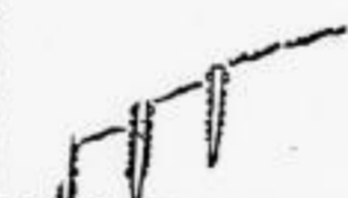
Abb. 6. Böschung durch Pfähle und Weidengeflecht befestigt
