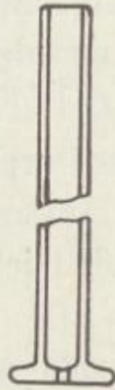
Abb. 90. Pipette mit Verteilungs- plättchen zum Gießen von Sensito- meterstreifen.
