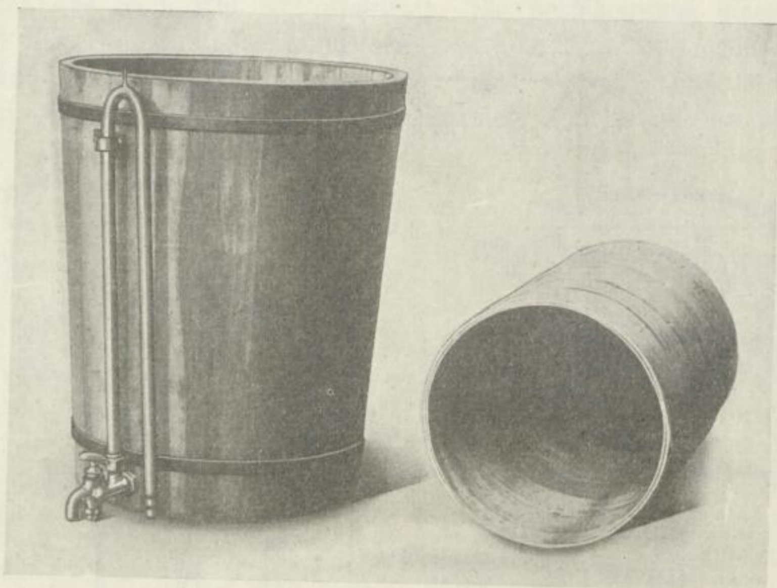
Abb. 34. Emulsions-Waschapparat mit Siebboden, Überlauf (und Rührwerk).
