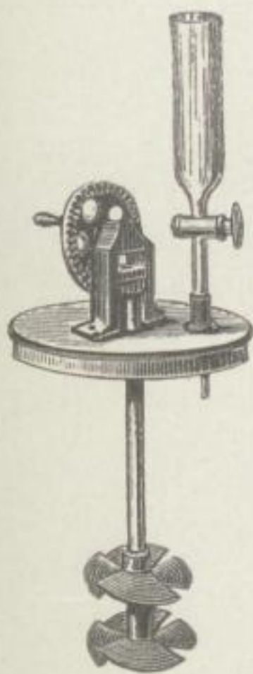
Abb. 22. Mischvorrichtung für Emulsionen.
