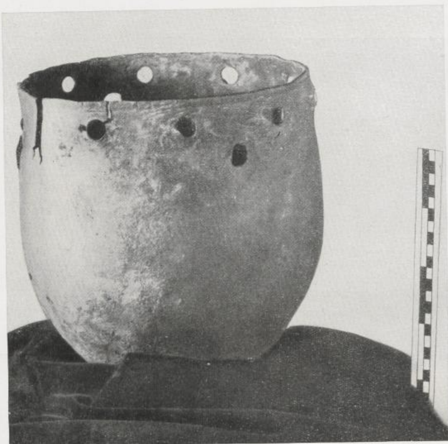
Abb. 45. Bronzeimer für die Wasserhaltung aus der Grube von Posada, Spanien (Originalaufnahme.)
