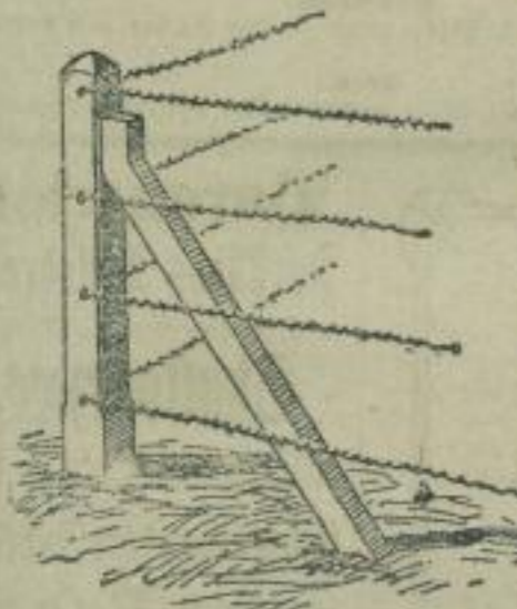
Zaunpfosten aus Beton.
