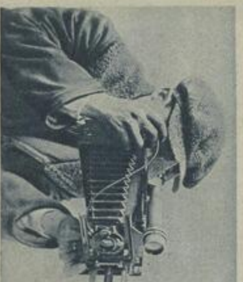
Links: Eine praktische Neuerung in der Photographie. Das mit dem Sucher verbundene Fernrohr ermöglicht Aufnahme von ganz besonderer Schärfe und Deutlichkeit
