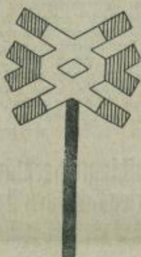
Mehrgleisiger Wegübergang ohne Schranken
