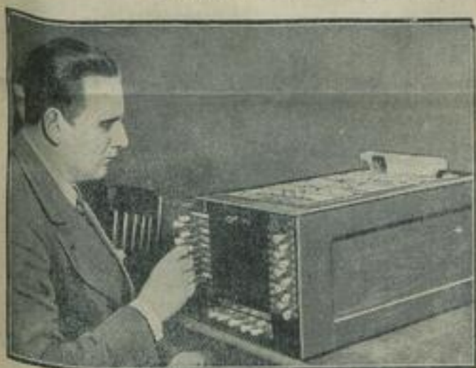
Eine Maschine, die Verbrecher sucht! Diese kleine Maschine wird gegenwärtig von der Polizei auf ihre Brauchbarkeit hin geprüft, da sie — nach Angabe ihres Erfinders — innerhalb kürzester Zeit jeden Verbrecher aus dem Verbrecherarchiv der Polizei herausfindet. Sind bestimmte Merkmale bei dem Gesuchten bekannt, so werden an den Hebeln die entsprechend bezeichneten Stangen gezogen. Der Apparat sortiert automatisch bestimmte Kartengruppen aus, bis schließlich die Karte des mit den bekannten Merkmalen übrigbleibt.
