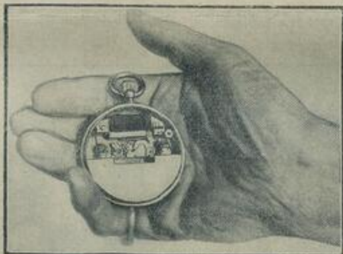
Deht auch elektrische Taschenuhren. Ein Denver Uhrmacher hat nach zwölfjährigen Versuchen eine Taschenuhr konstruiert, die nur die Größe einer gewöhnlichen Taschenuhr hat und elektrisch angetrieben wird. Das Uhrwerk wird von einem kleinen Akkumulator angetrieben, der jederzeit wieder aufgeladen werden kann.
