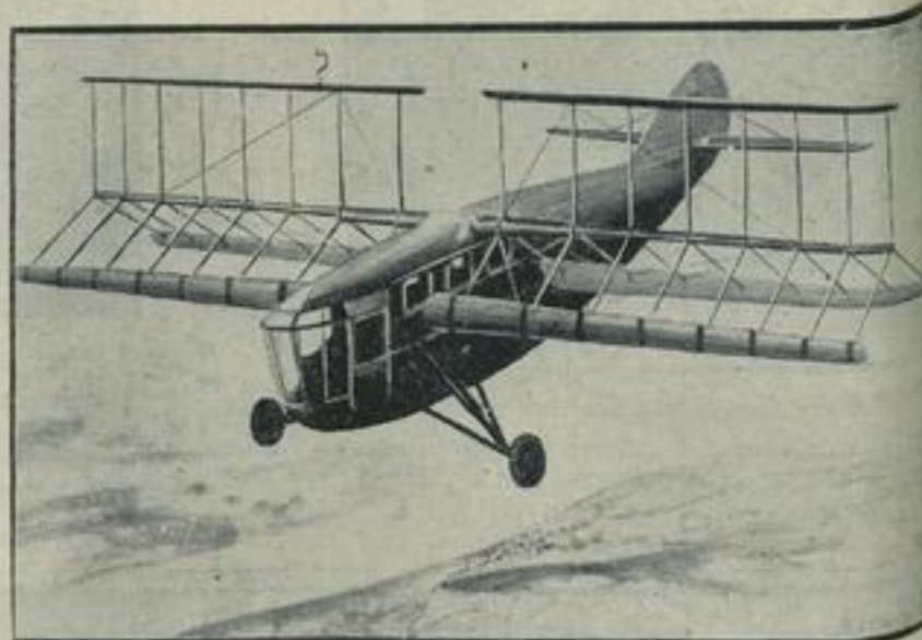
Das erste Schaufelradflugzeug. In der Berliner Werk der Rohrbach-Flugzeugwerke ist mit dem Bau eines neuen Flugzeuges begonnen worden, das eine Annäherung in der Luftfahrt bringen soll: das Flugzeug stellt eine Verbesserung der Autogiro-Dee dar und wird nur durch rotierende Flügel angetrieben, so daß Start und Landung vollkommen senkrecht erfolgen können.
