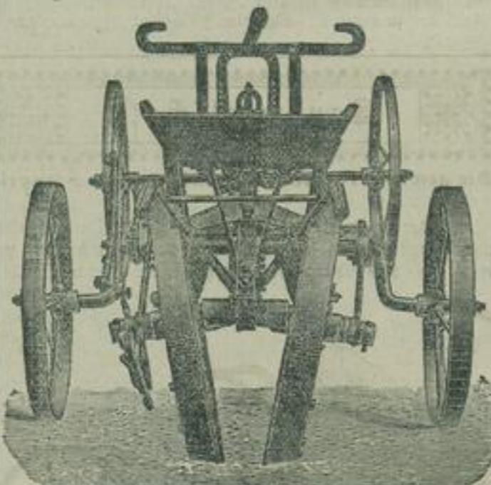
Fig. 3. Näsenscheidemaschine von Paul Behrens, Magdeburg, Arbeitsstellung, von hinten gesehen.
