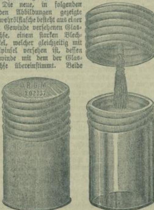
Teile werden von einer soliden Blechhülse umschlossen, die sich mittelst Gewinde an den Büchsendeckel anschließen läßt. Das Ganze gewährt einen zuverlässig dichten Verschluss, sichert große Sauberkeit und Haltbarkeit, ist sehr einfach und läßt sich schnell und leicht öffnen und schließen. Besonders wichtig ist, daß die Delffläschche durch die umschließende Blechhülse vor dem Zerbrechen in sicherer Weise geschützt wird.
