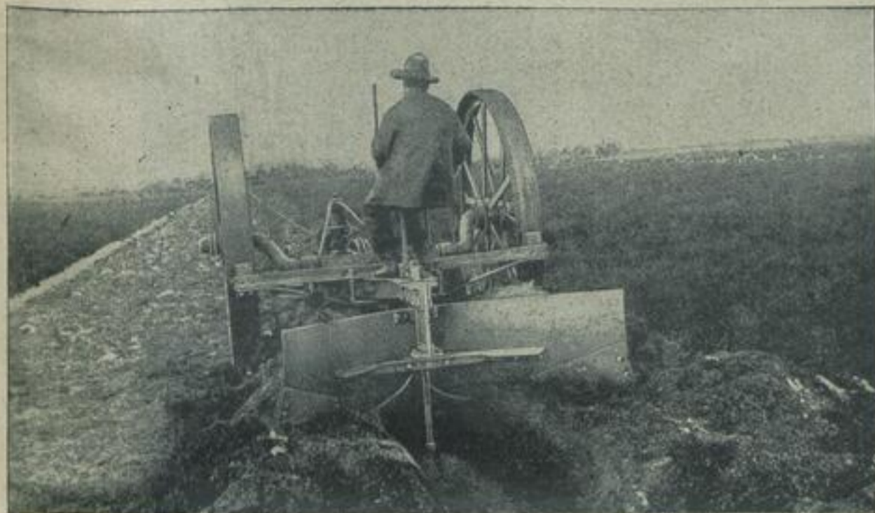
Ein Automobilpflug zum Aufwerfen von Schützengräben.
