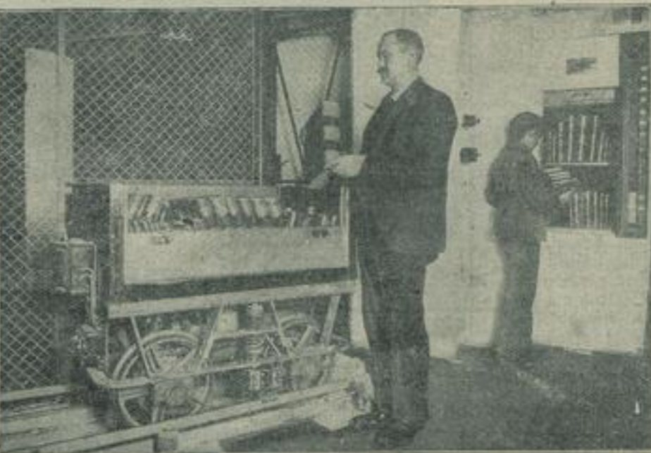
Elektrisch betriebener Büchertransportwagen und Fahrstuhl im Bücherlager.
