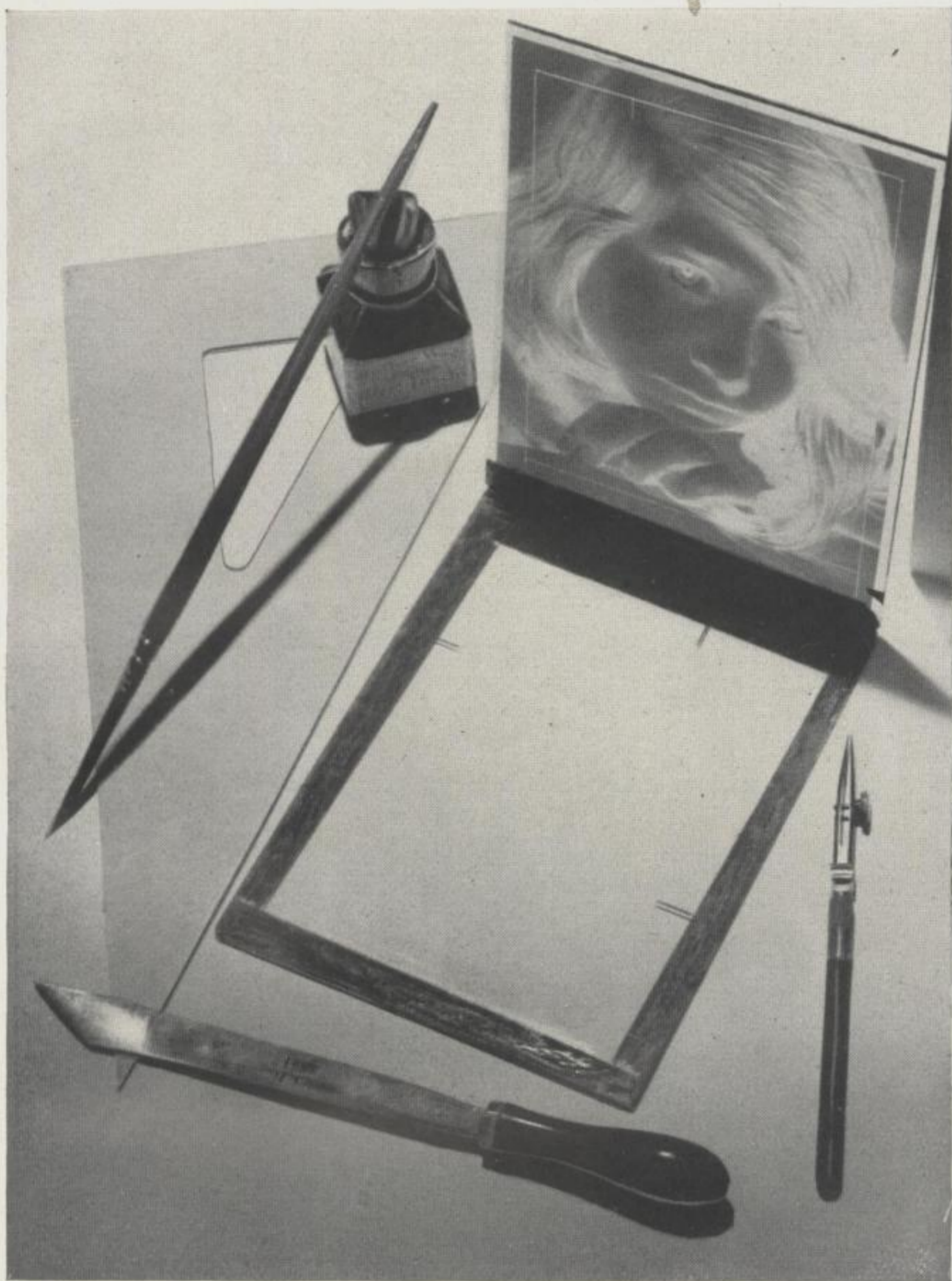
Abb. 1. Das richtige Anbringen der Paßmarken und die dazu erforderlichen Werkzeuge.
