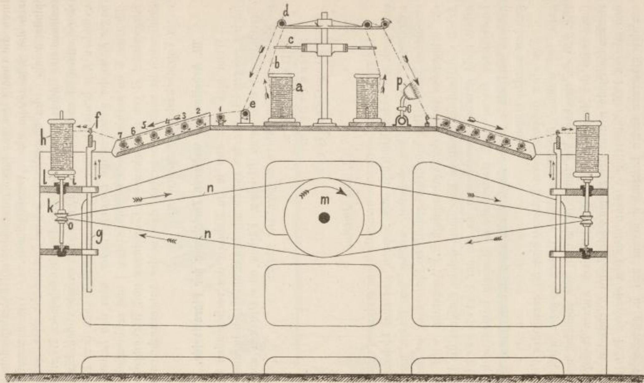
Fig. 120. Doppelte Fadenputz- und Sengmaschine. (Verticaler Querschnitt.)
