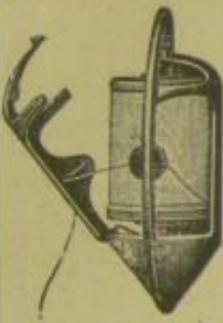
**die rotirende Zweispulen-Maschine**
