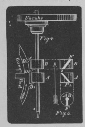
F, des Cylinders A zuwendet, greift dieser Zahn daselbst ein, gleitet auf der geneigten Fläche fort und gibt der Unruhe der Zahn auf der Fläche 2 des Cylinders B. (Diese neue Lage wird durch den punktirten Zahn D2 angedeutet.)
