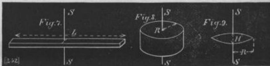
b) Ein Kreiszylinder von der Masse  $M$  und dem Radius  $R$  drehe sich um seine geometrische Achse, Fig. 8 so beträgt das Trägheitsmoment in bezug auf diese Achse
