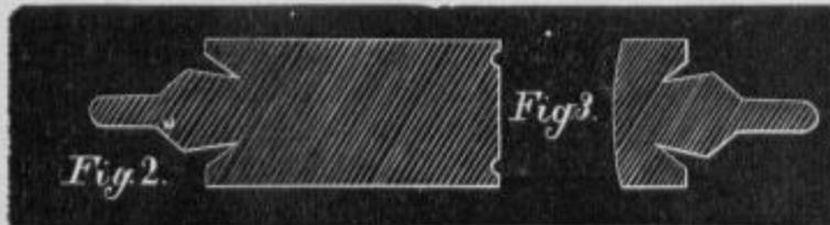
3. Infolge dieser doppelt so grossen Wandstärke, die überall am Cylinder vorhanden ist, ausgenommen an der Ausgangs-Lippe, bietet der neue Cylinder in seinem ausgeschnittenen unteren Theile genügenden Widerstand, um jede Erschütterung auszuhalten.
