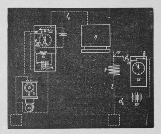
diese angeschlossenen Leitungen lo und Apparate zur Erde und durch diese zurück zum anderen Pol der Batterie w fliesst.
