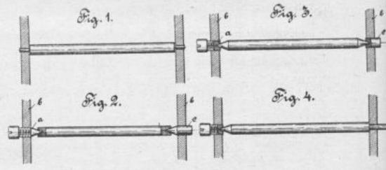
Die dünnen Zapfen sind natürlich gegen äussere Einwirkungen sehr empfindlich, ein geringer Druck verbiegt sie, wodurch der centrische Lauf der Achsen und der richtige Eingriff der Räder beeinträchtigt wird. Muss alsdann eine solche Achse ausgewechselt werden, so ist erforderlich, die Uhrwerke fast ganz auseinander zu nehmen, weil durch das Heben der Platine zur Entfernung der einen Achse die Zapfen der übrigen Achsen auch aus den Oeffnungen gleiten.
