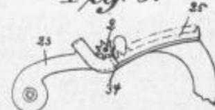
der Rechen gleichzeitig hebend auf den Arm 23 ein, welcher letzterer wieder auf den Arm 21 hebend oder drehend wirkt. Die in dieser Art hervorgerufene Bewegung der einzelnen Teile bewirkt, dass die Schaltklinke 8 mit dem Schaltrad 4 ausser Eingriff kommt.
