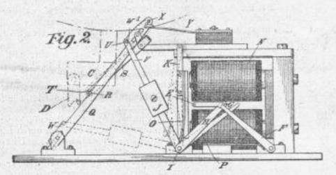
geringe Kraft auf das Pendel zu übertragen und diese Kraft erst während die Anziehungskraft immer grösser wird, je mehr sich nach und nach so zu vergrössern, dass das Pendel in ausreichendem Masse Antrieb erhält, ohne dass dabei die Regelohne Beeinträchtigung der Regelmässigkeiten seiner Schwingungen erfolgt, was für eine genaue Zeitangabe von grosser Wichtigkeit ist.
