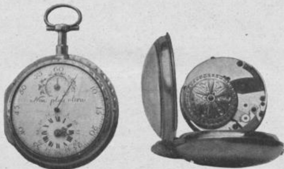
Fig. 31. Goldene Zylinderuhr mit selbsttätigem Hammeraufzug um 1780.
