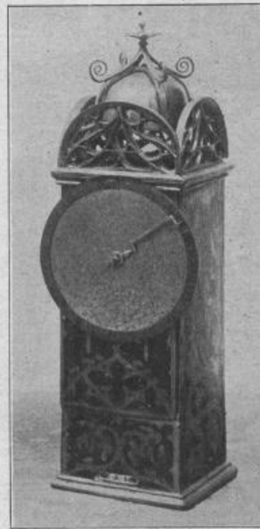
Fig. 11. Gotische astronomische Uhr mit Federzug. (Germ. Museum, 1500—1520.)
