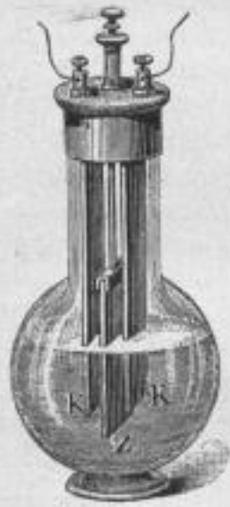
Fig. 14. Das Tauch-Element. Bunsen-Chromsäure-Elementes ohne Tonzylinder.
