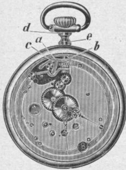
Auch beim Selbstlösen der Schraube *c* ist ein Verlieren der dadurch lose werdenden Welle unmöglich, da das Futter *d* den Ansatz *e* der Welle nicht durchlässt.
