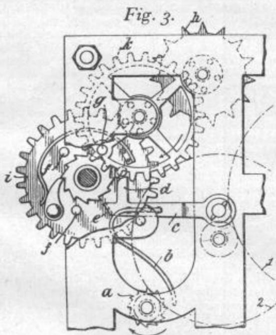
wird in bekannter Weise durch das Rad *k* und das Rad *h* der Anker *m* und der Hammerbengel *n* in Schwingung versetzt.
