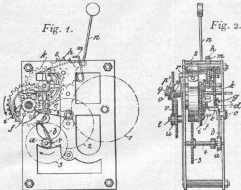
werkes vorgesehenen Sperrstift *g* entweder festhält oder freigibt, und an dem vorderen Ende des Armes *c* ist ein schräg liegender, nach innen hineinragender Vorsprung *e* angeordnet, welcher von den an der Trummel *i* des Weckerwerkes angebrachten Mitnehmerstiften *f* beeinflusst wird. Von der Weckertrummel *i* aus
