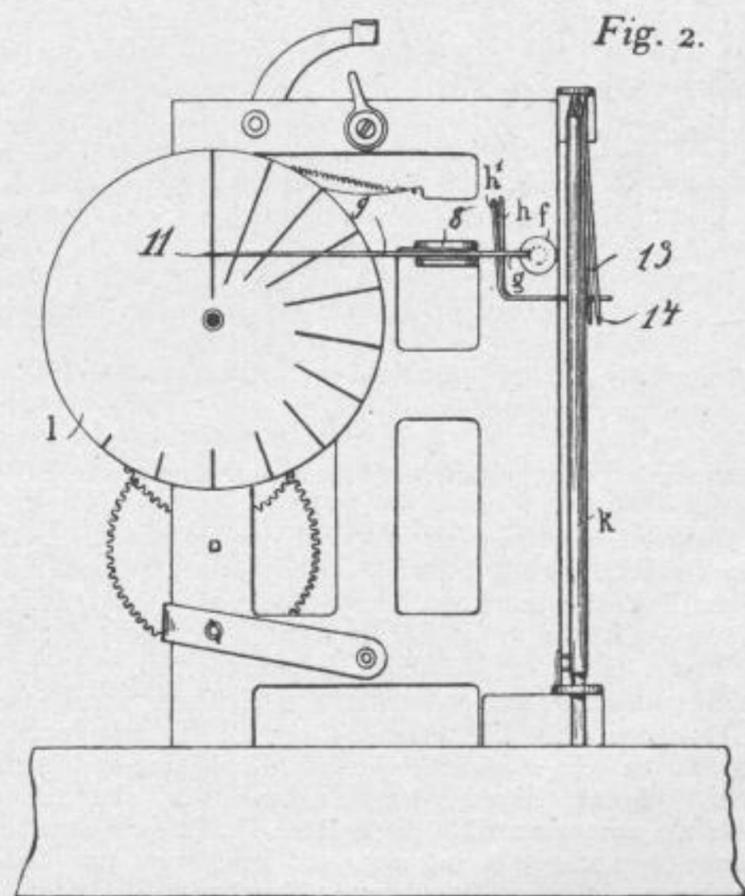
während einer Stunde eine volle Umdrehung, das Rad  $b$  wird daher für jede Viertelstunde eine der Zahnweite entsprechende Drehbewegung machen und während zwölf Stunden eine vollständige Umdrehung zurückgelegt haben. Mit dem Rade  $b$  sitzt auf derselben Welle 5 das Schneckenrad  $c$  mit 48 stufenartig angeordneten Zähnen an seinem Umfange. Auf dem stufenartig gebildeten Umfang dieser Schnecke gleitet das Zäpfchen 6 eines um eine Achse 7 schwingenden Hebels  $e$ . Auf derselben Welle 7
