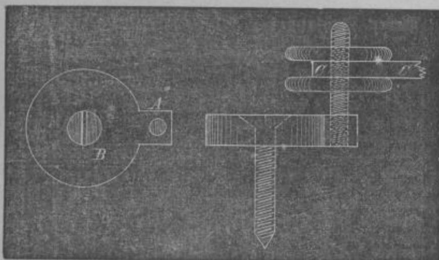
hängt, genau senkrecht gerichtet und durch das Loch B ein deutlich sichtbares Zeichen an der Wand gemacht. Nachdem der Regulator wieder abgenommen, wird auf dieser Stelle mit dem Hartmeißel ein kleines Loch in die Wand getrieben zur Aufnahme eines harten Holzstückes an das, nach wieder erfolgtem Aufhängen des Regulators, mittelst der eingepaßten Holzschraube das Messingstück fest angeschraubt wird. Natürlich muß das Loch gut zugedeckt werden.
