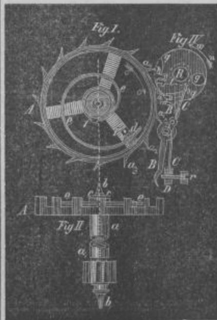
Innerhalb der Zeit, bis die Unruhe zwei Oscillationen gemacht hat, d. i. beim Synchronometer gleich  $1\frac{1}{2}$  Sek., steht das Steigrad in Ruhe und mittelweile
