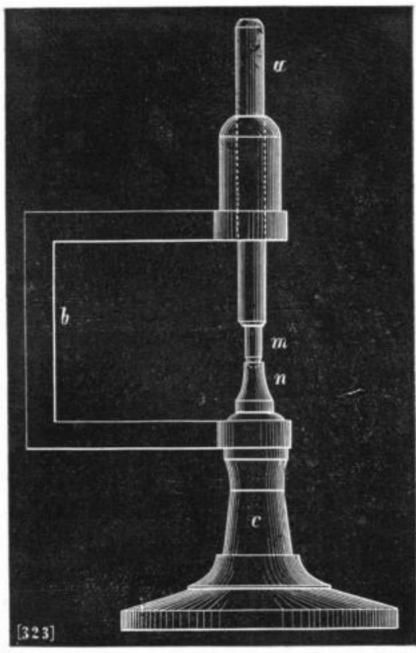
ein Gegenstützpunkt m aus gleichem Material, welcher von einem gekrümmten Arm b getragen wird und nach Bedürfnis höher oder niedriger eingestellt werden kann und in welchem sich die Welle a frei bewegt, drückt beim Gebrauch auf das Futter der Zeiger, welche befestigt werden, indem man mit der Hand oder mit einem kleinen Hammer auf das äusserste Ende des Gegenstützpunktes Druck ausübt. (Journ. suisse d'horl.)
