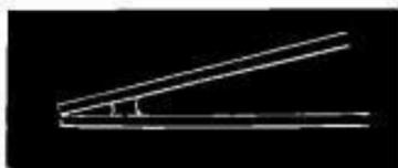
Taucht man einen Stab, welcher cylindrisch oder konisch ist, in Oel, so wird sich das Oel auf seiner ganzen Länge vertheilen; ist er aber mit einer Verdickung am eingetauchten Ende versehen, wird sich hier ein Tropfen bilden.
