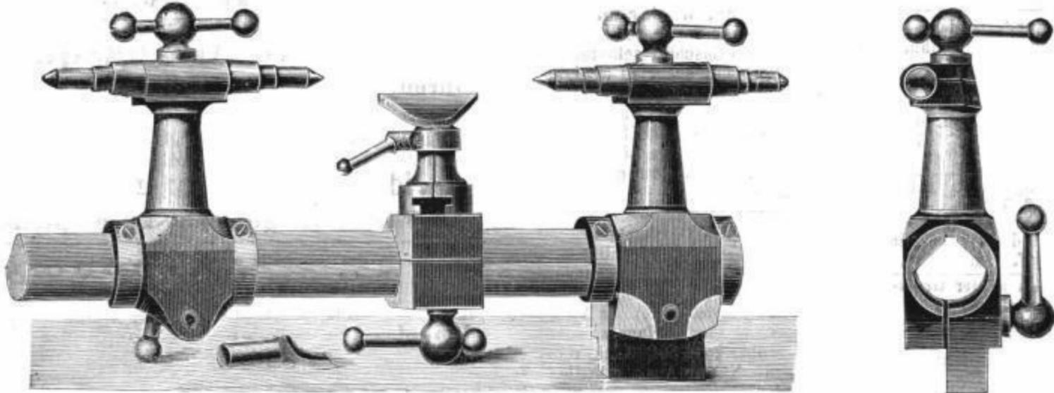
Der Patent-Drehstuhl hat runde Stange mit prismatischen Führungsflächen, wodurch eine seitliche Abweichung der Spitzen vollständig ausgeschlossen ist.
