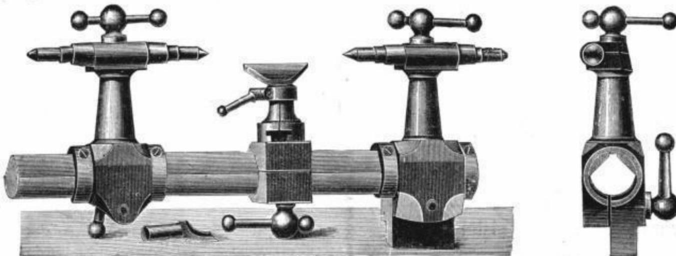
Der Patent-Drehstuhl hat runde Stange mit prismatischen Führungsflächen, wodurch eine seitliche Abweichung der Spitzen vollständig ausgeschlossen ist.
