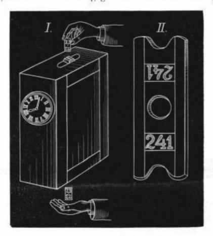
dadurch die Nummer derselben auf einem fortlaufenden Papierstreifen abdruckt. Ein Uhrwerk, das nach aussen hin ein Zifferblatt trägt, im Innern des Kastens jedoch Zahlenscheiben genau mit dem Stunden- und Minutenzeiger korrespondirend weiter bewegt, bewirkt, dass neben der Nummer der Blechmarke die Zeit in Stunden und Minuten auf dieselbe Art abgedruckt wird. Die Aufzeichnungen auf dem Kontroll-Papierstreifen erscheinen Zeit: U.M. dann wie folgt:
