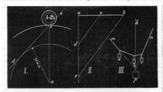
durch den Schnittpunkt o derselben mit der Mittellinie mittels der somit ermittelten Halbmesser ao für das Rad und bo für das Trieb die entsprechenden Grundkreise
