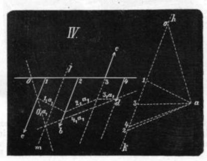
Ein zu interessanten praktischen Ergebnissen führendes graphisches Verfahren lässt sich mit Hilfe des sogenannten Kettenpolygons ausführen; es ermöglicht die leichte Auffindung der Resultante paralleler Kräfte.
