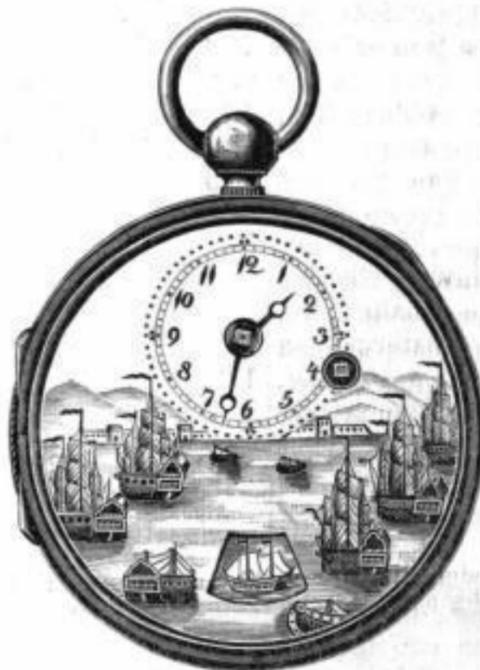
Spindeluhr mit Wandelbild und gemaltem Zifferblatt; auf der verlängerten Welle des Zwischenrades ist eine mit Schiffen bemalte Elfenbeinscheibe befestigt.
