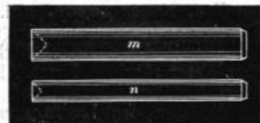
Fig. 7. Punzen zum Verengen der Federhauslöcher.
