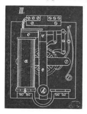
erhält und weiter schwingt. Gleichzeitig war der Stift k in die anker gelagert, welcher durch den Stromimpuls in eine rotierende Zahnlücke gelangt und der entsprechend nächste Zahn stützte oder sehwingende Bewegung gesetzt wurde und dadurch den
